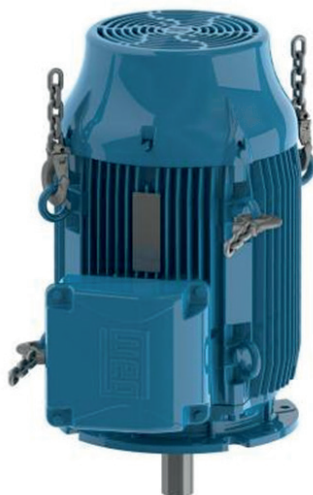
Figura 4.20: Instalação do segundo par de olhais
