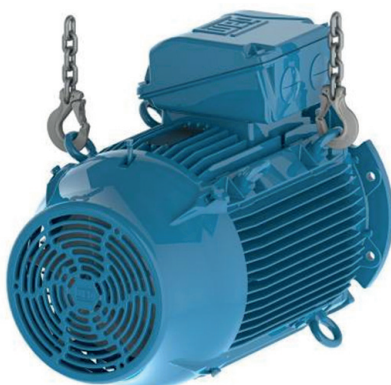
Figura 4.22: Resultado final: motor posicionado na posição horizontal
