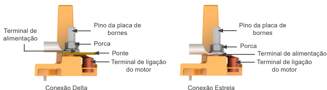
Figura 6.15: Conexão dos cabos para motores com placa de bornes KWLV e KWMV
