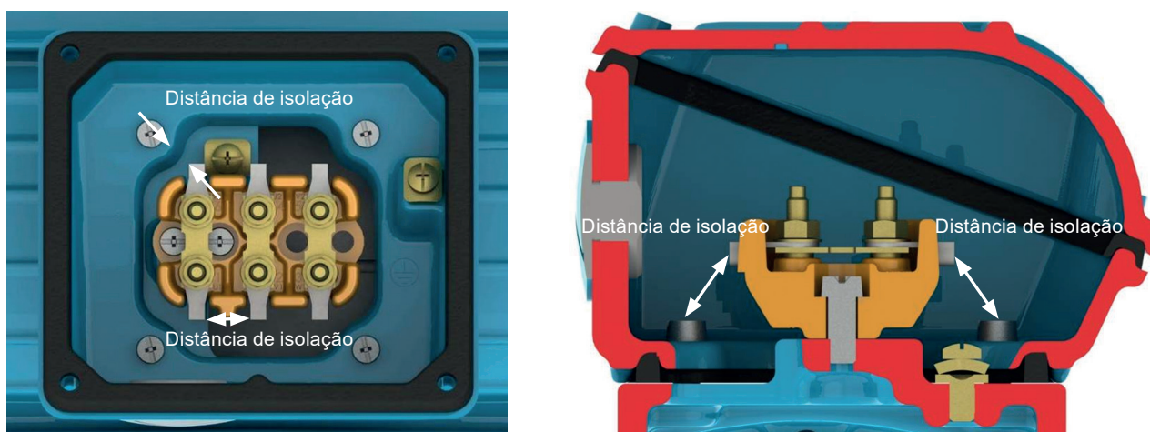
Figura 6.16: Representação da distância de isolamento
